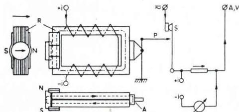
Die hohe Empfindlichkeit des Relais ergibt sich durch die Anwendung des Prinzips der Sättigungssperre. Der Relaisanker A, der mit einer Kontaktfeder S verbunden ist, wird durch einen permanent-magnetischen Fluß am Relaisjoch R gehalten. Bei einer bestimmten Erregung der Relaiswicklung
