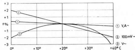
Anmerkung: Ein negativer, zusätzlicher Fehler bedeutet, daß das Instrument zu wenig anzeigt, daß also der wahre Wert um den entsprechenden prozentuellen Betrag größer als die Anzeige ist.
