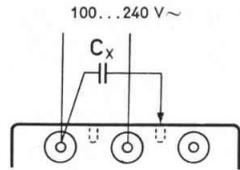
Anschluß: **Wechselstromfremdspannung** direkt an die Klemmen des Unigor legen. Zu messende Kapazität  $C_x$  an die Klemme  $\ominus$  und  $\mu\text{F}$ -Steckbuchse anschließen.
