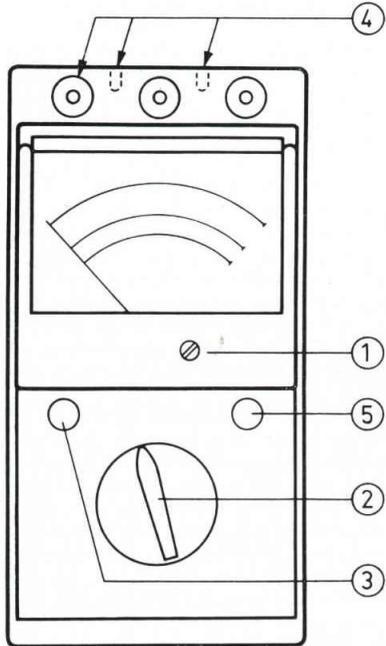
① Im stromlosen Zustand Nullpunkteinstellung kontrollieren. Nach einer Reinigung des Skalenfensters die elektrostatische Aufladung durch Anhauchen, Berühren des Glases oder durch Abwischen mit einem feuchten Tuch ableiten.
