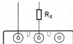
Anschluß: Widerstand  $R_x$  zwischen einen Pol der **Gleichstrom-** bzw. **Wechselstromfremdspannung** und eine Klemme des Unigor legen.
