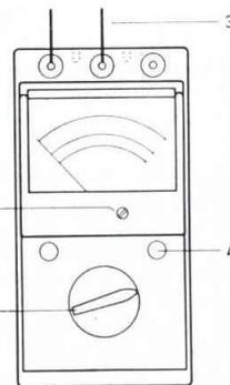
Schwarze Anschlußklemmen entsprechend dem gewählten Meßbereich an Gleich- oder Wechselspannung anschließen. Bei Kapazitätsmessungen gilt der Meßspannungsbereich nur für Frequenzen von 45 bis 65 Hz. Die Anzeigegenauigkeit ist von der Frequenz unabhängig
