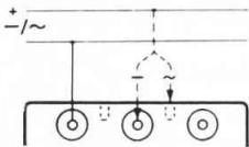
Die Wechselspannungsmessung wie bereits beschrieben durchführen. Die Anzeige wird wegen des in Serie mit Innenwiderstand liegenden Kondensators bei niederen Frequenzen frequenzabhängig (siehe Tabelle).
