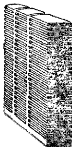
Фиг. 31. Акумулаторна оловена плоча съ голѣма външна повърхностъ.
