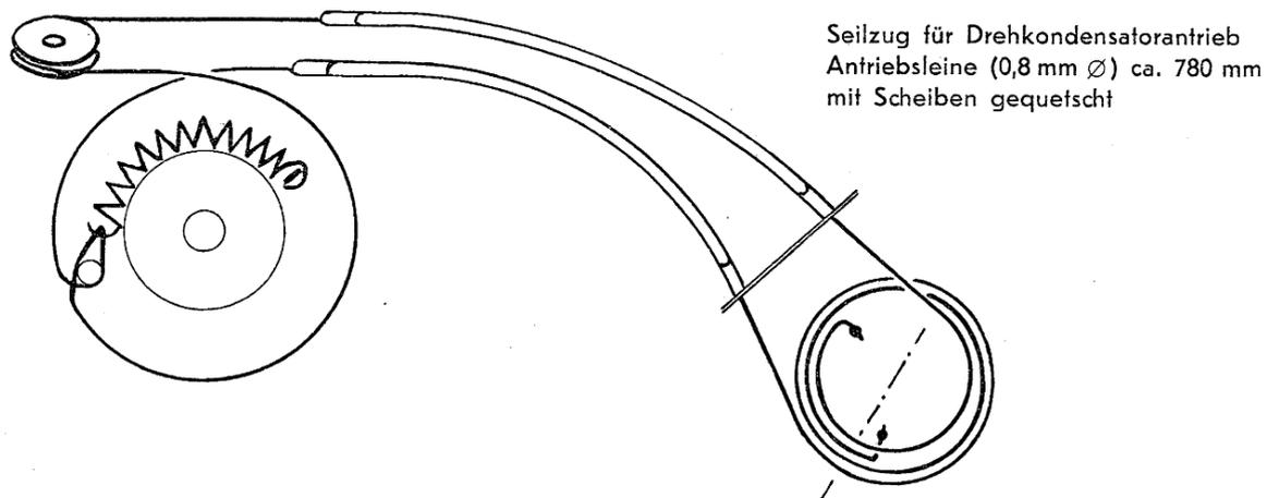
Seilzug für Drehkondensatorantrieb
