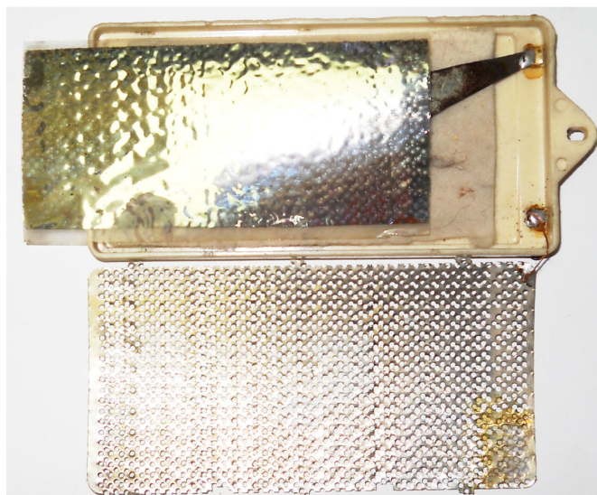
Фиг. 6. P-BK10/5 - в разглобен вид.
