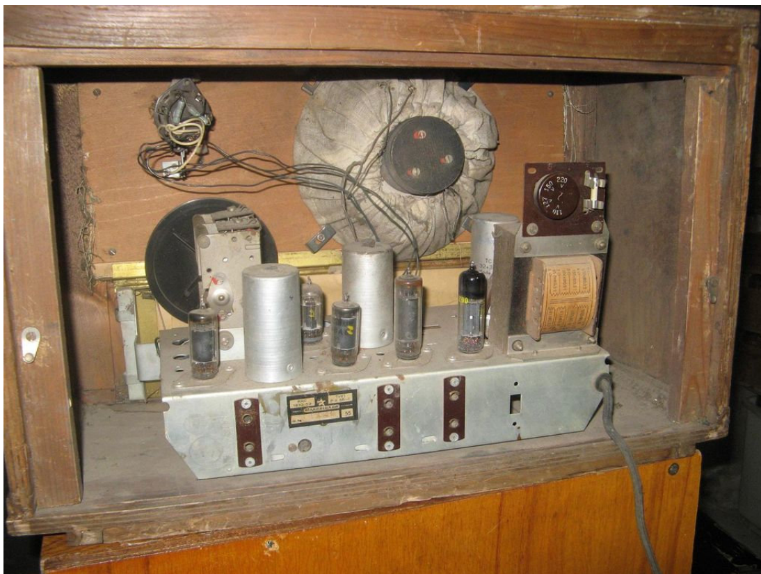
Радиоприемник „Христо Ботев“ (6BE6, 6BA6, 6AT6, 6AQ5, 6X4 и 6M4)
